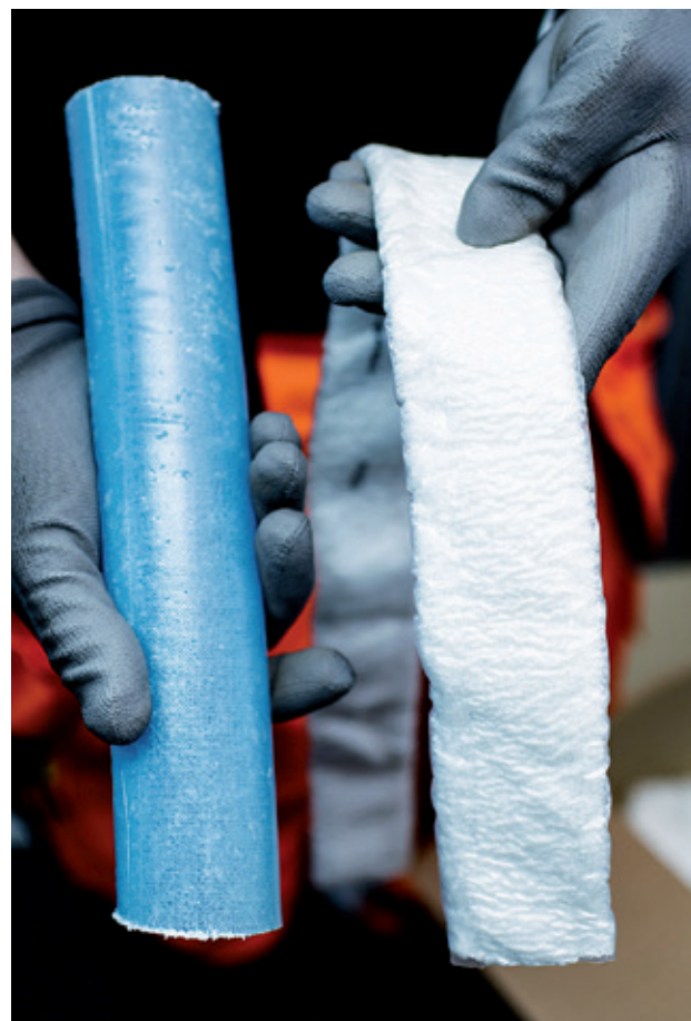
Sukitusmenetelmän avulla tehdään uusi itsekantava ja kova muoviputki vanhan putken sisään.
