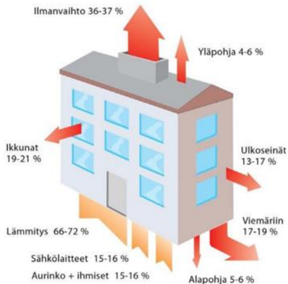
Kuva: Kerrostalon lämpötase 60-80-luvun kerrostaloissa
